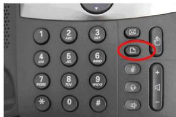
Después seleccione “Network” y obtendrá “Current IP” que reflejará la IP actual del aparato y que necesitaremos para acceder al equipo.
